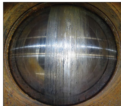
Rysunek 3. Eksploatacyjne zarysowania kuli w zaworze z kulą pływającą spowodowane przez tarcie na styku siedlisko kuli/kula
